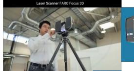
FARO社 Laser Scanner Focus(三脚固定型)
